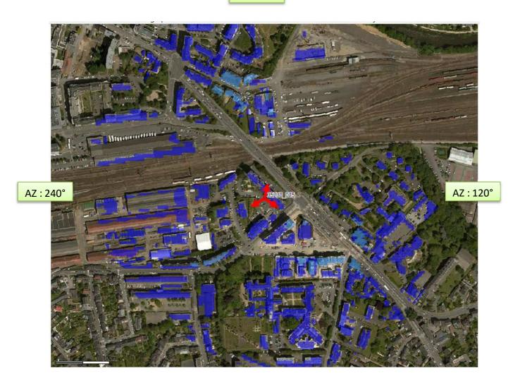
À 1,5 m du sol, le niveau maximal simulé en intérieur pour les antennes à faisceaux orientables est compris entre 1 et 2 V/m.
