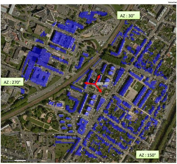
À 1,5 m du sol, le niveau maximal simulé en intérieur pour les antennes à faisceaux orientables est compris entre 0 et 1 V/m.
