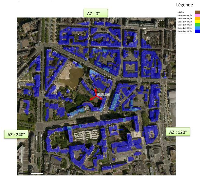
À 1,5 m du sol, le niveau maximal simulé en intérieur pour les antennes à faisceaux orientables est compris entre 1 et 2 V/m.
